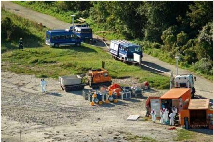
Auf dem Priwall liegen die Geräte für eine Ölsperre und Ölskimmer zum Aufsaugen des Öls von der Wasseroberfläche. Man erkennt die schräg aufgestellten Skimmer an den drei orangefarbenen Schwimmern. Foto: KARL ERHARD VÖGELE
