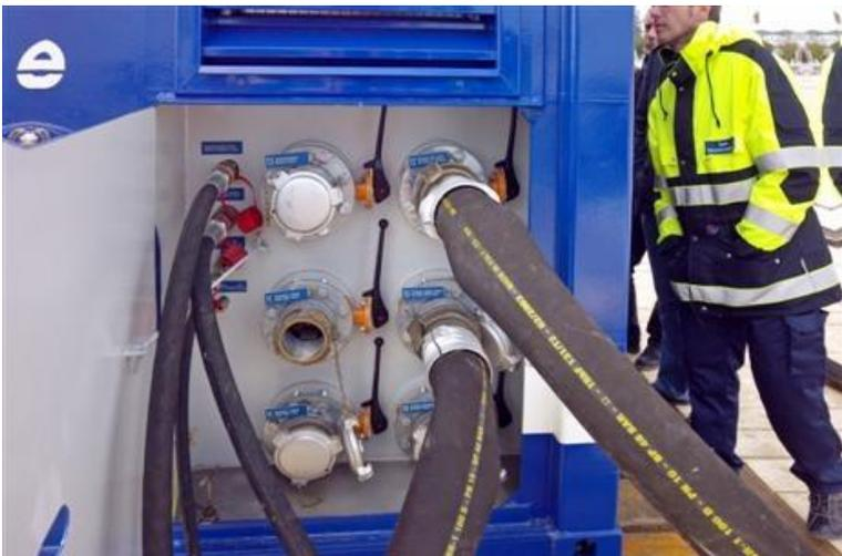
Mit diesen gewaltigen Schläuchen wird das Öl-Wasser-Gemisch vom roten Auffangbehälter, das der Ölskimmer aufgenommen hat, in den Separator gepumpt und getrennt. Die Leistung eines der vorhandenen Separatoren beträgt 160 cbm pro Stunde. Foto: KARL ERHARD VÖGELE
