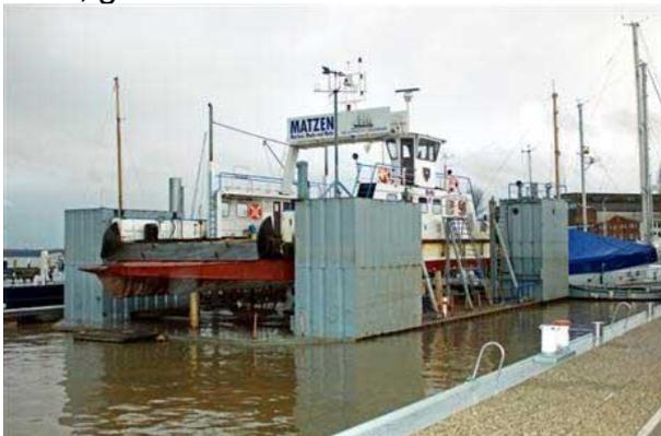
Ein Blick zurück in die Böbswerft: Die »Berlin« wurde aufgeschwommen um das Unterwasserschiff und die Opferelektroden zu erneuern.
