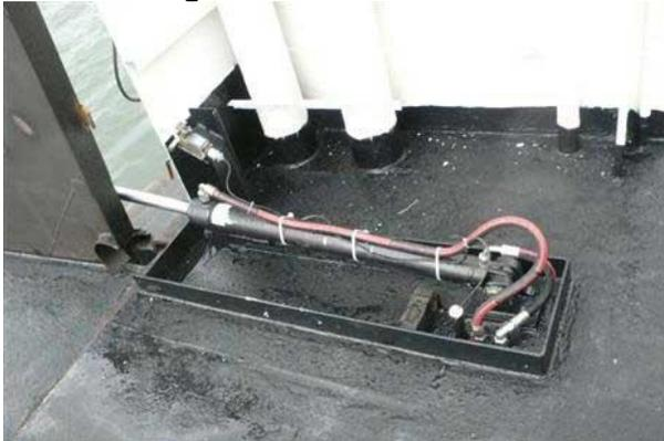
Erneuert wurde die Hydraulik an den beiden Auffahrklappen.
