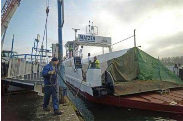
Der »Balkon« ist nun fürs Abnehmen vorbereitet, damit die Fähre künftig auf der Böbswerft ins Schwimmdock passt. Hier wird der »Balkon« angesetzt. Damit sind die größeren Arbeiten für die Renovierung der Fähre abgeschlossen.
