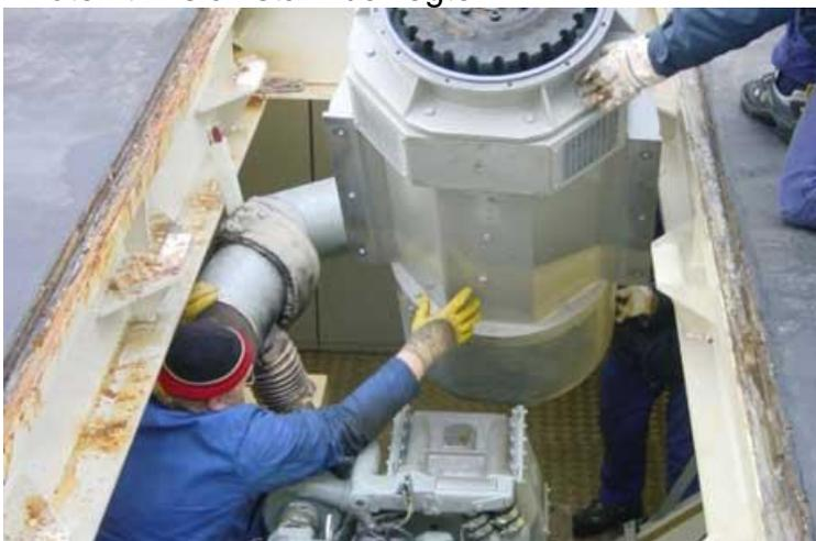
Einbau eines Generators an das Dieselaggregat im Maschinenraum der »Pötenitz«.
