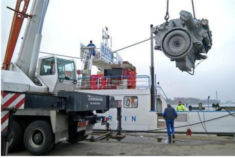
Einer der beiden generalüberholten 10 Zylinder-Diesel-Viertaktmotoren mit 179 PS wird an Bord gehievt.
