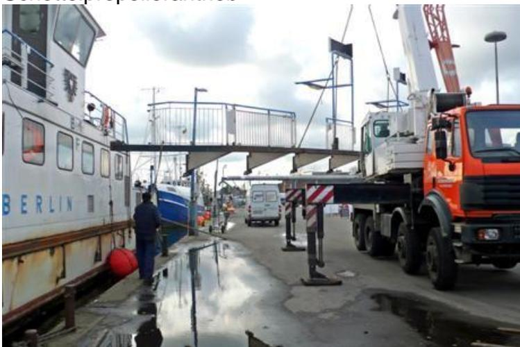
Der »Balkon« der Fähre wurde abnehmbar gemacht. Die Fähre wird schmaler und kann in einer hiesigen Werft überholt werden. Sie braucht deswegen nicht mehr mit Schlepperhilfe nach Kiel.
