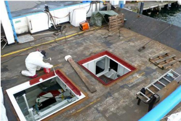
Links, blitzblank der Motorschacht, rechts der Schacht für den Schottelpropellerantrieb
