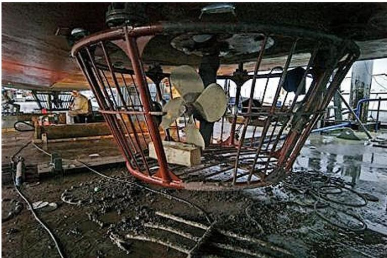
Die um 360 Grad drehbaren Schottelpropeller erlauben der »Berlin« äußerst wendige Manöver. Sie kann praktisch ohne den Schiffskörper zu drehen, in alle Himmelsrichtungen fahren. Die Schottelpropeller sind zum Schutz gegen Beschädigung mit einem Gitter umgeben.
