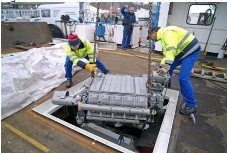
Mitarbeiter des Fährbetriebes bugsieren millimetergenau einen der beiden Motoren zur Montage in den Motorschacht. Im Hintergrund Firmenchef Tiedemann, der dem Kranführer Zeichen zum genauen Positionieren des Motors gibt.
